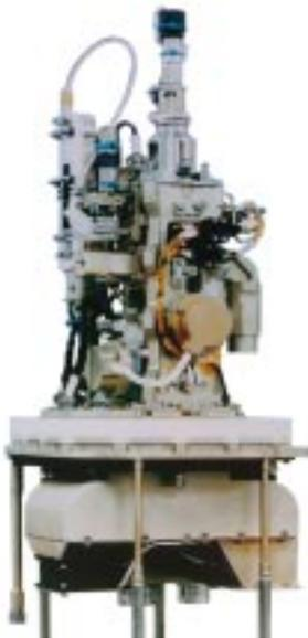
↑ Le Laboratoire du Dr. G. Pétré a mis au point cet appareil FAST (Facility for Absorption and Surface Tension) d'étude des processus qui se passent aux interfaces liquides. (Doc. ULB)
