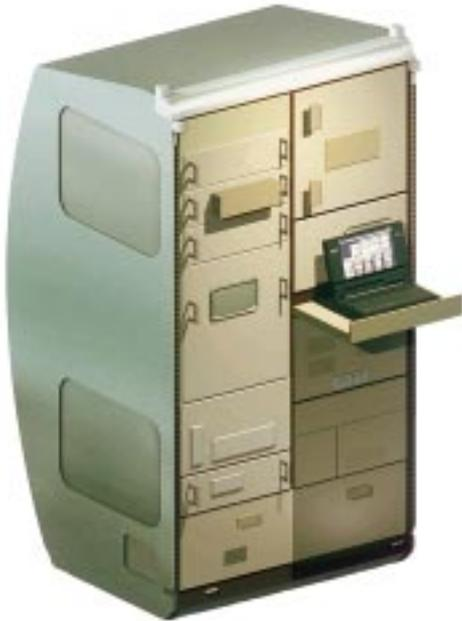
↙ Cet ensemble Fluid Science Laboratory d'instruments opto-électroniques pour l'étude du comportement de liquides en impesanteur doit prendre place à bord d'un module de l'International Space Station. Il est réalisé par un consortium européen dont les partenaires belges sont le Microgravity Research Center et la société Verhaert. (Doc. ESA)
