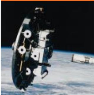
← Cette plate-forme automatique WSF (Wake Shield Facility) a été mise au point par la société privée Space Industries Inc. Larguée puis récupérée au moyen du bras télémanipulateur de la navette, elle a servi à tester de nouveaux processus industriels en microgravité. (Photo NASA)
