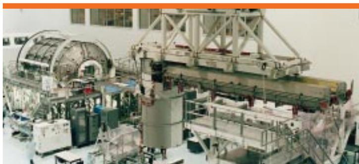
← Côte à côte, le mini-module Leonardo "made in Italy" pour les opérations de maintenance et la structure des rouleaux de cellules solaires pour l'alimentation électrique de l'International Space Station. (Photo NASA)
