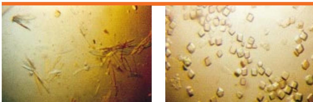
← L'équipe du Professeur Martial a cristallisé des protéines artificielles d'octarelline : à gauche, les cristaux obtenus au sol et, à droite, les cristaux produits dans l'espace. (Doc. ULg)
